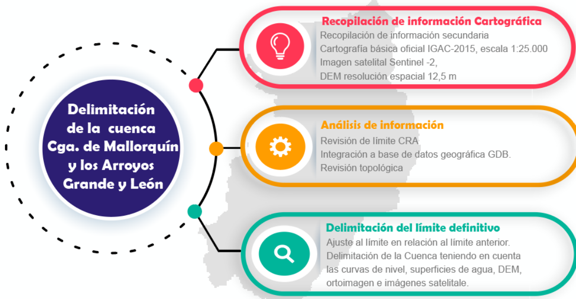
Figura 1.14. Esquema metodológico de ajuste de la delimitación del área de la cuenca
